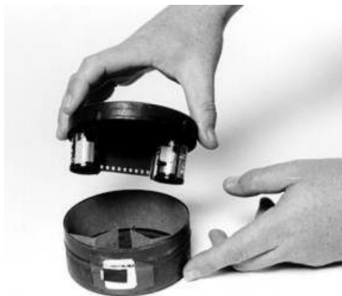
Ilust. 11: Câmera pinhole de lata adaptada para filme 35mm, autor desconhecido. Fonte: Manual prático de fotografia pinhole . 19
