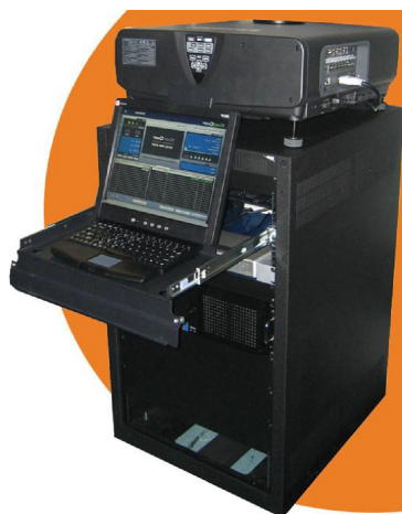
Figura 3: Kinocast – equipamento para salas digitais: em cima está o projetor, embaixo o servidor e um notebook mostrando a interface do software de gerenciamento de arquivos.
